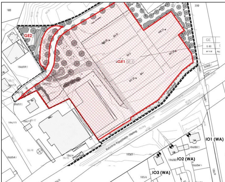
Abbildung 8: Lageplan mit Eintragung der maßgeblichen Immissionsorte IO
